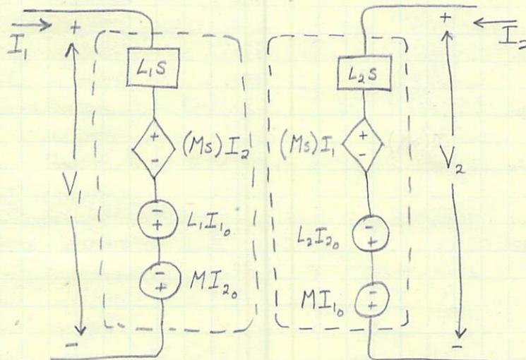
THE  $V_2, I_2$  SIDE IS BASED ON SYMMETRY.
